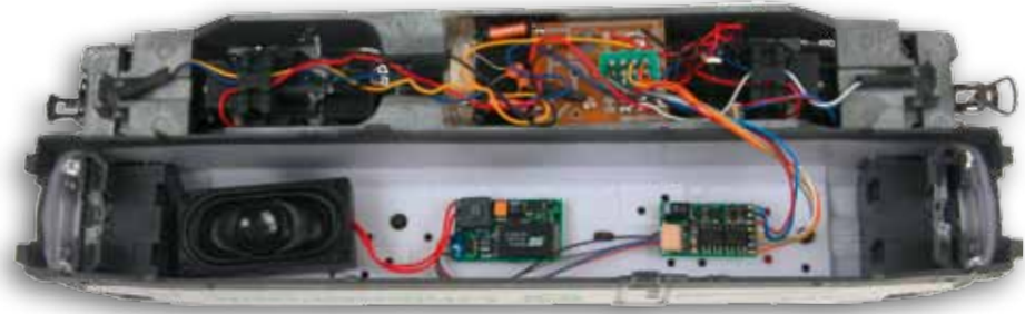
Decoder 76 420, Soundmodul 32 100 und Lautsprecher 31 130 eingebaut in PIKO Taurus. Siehe Titelseite.
