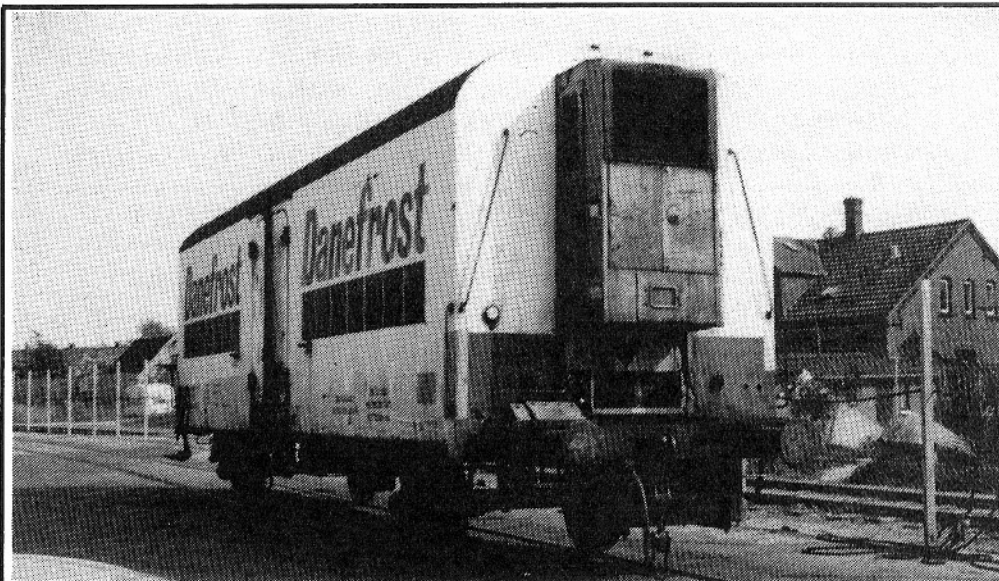
Kølemaskinen på 084 001-0. Tv. for kølemaskinen sidder et termometer til aflæsning af temperaturen inde i vognen (Foto: Udlånt af Per Poulsen - NYBORG LYNFROST).
