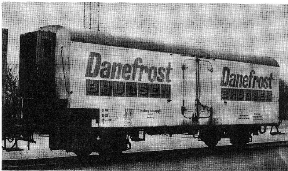
084 4 000-2 med de nederste påskrifter ændret samt u/bremsehjørner og u/RIV'-mærke og DSB på vognkassens højre side (Foto: Udlånt af P.T.N.).
